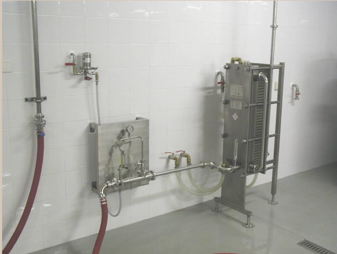
Napowietrzanie brzeczki i schładzacz brzeczki.
