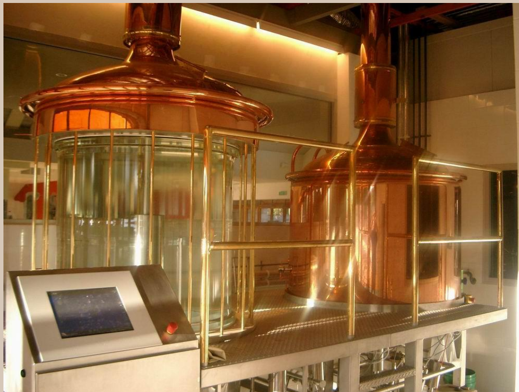
Warzelnia 10 hl - szkło połączone z miedzią.
